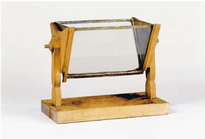
Abb. 13. Goethes Wasserprisma, links und rechts mit gleichseitig dreieckiger Grundfläche (Foto: Goethe-Nationalmuseum Weimar, Klassik Stiftung Weimar, Bestand Museen, Inv. Nr. GNF 0089).
